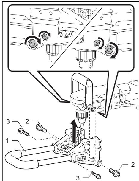
► 1. Empuñadura lateral 2. Perno A 3. Perno B
