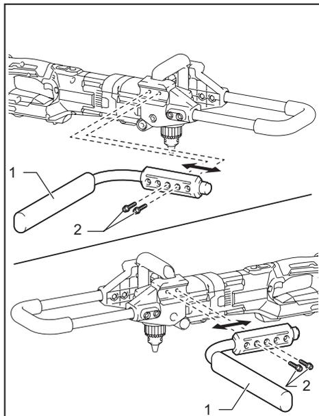
► 1. Barra del receptor de reacción 2. Perno C
