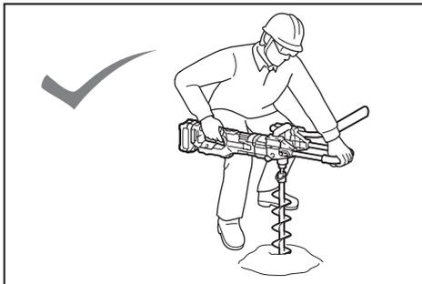
**⚠PRECAUCIÓN:** Sujete la herramienta firmemente. La herramienta podrá retroceder de forma abrupta y ocasionar heridas.
