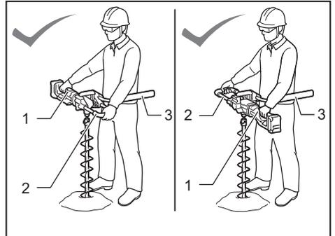
► 1. Mango 2. Empuñadura lateral 3. Barra del receptor de reacción
