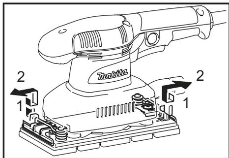
Presione la palanca de bloqueo (1 en la figura) y con la palanca de bloqueo presionada, deslícela hacia la herramienta (2 en la figura) y el fijador se liberará. Inserte el extremo del papel entre un fijador y el plato alineando los orificios del papel con los del plato. A continuación, devuelva la palanca de bloqueo a la posición original para fijarla.
