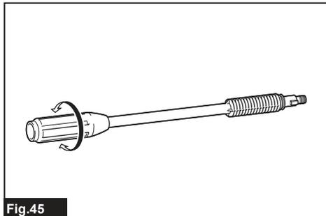
La presión del chorro se puede ajustar girando la boquilla.
