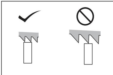
Aplique la hoja de sierra de banda a la posición de corte apropiada de la pieza de trabajo como se muestra en la ilustración.
