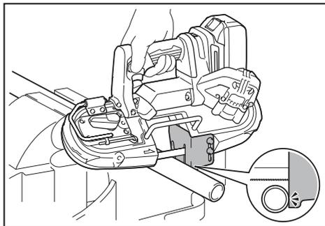
2. Encienda la herramienta y espere hasta que la hoja de sierra de banda adquiera plena velocidad. Baje con cuidado la hoja hasta el corte. Con el peso de la herramienta o presionando ligeramente la herramienta se proporcionará la presión adecuada para el corte. No fuerce la herramienta.
