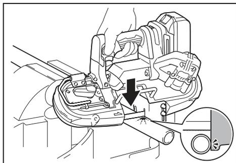
3. Conforme alcance el final de un corte, libere la presión y levante la herramienta ligeramente de forma que no se caiga contra la pieza de trabajo.
