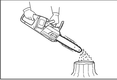
**AVISO:** Cuando la sierra de cadena sea utilizada por primera vez, puede que lleve hasta dos minutos para que el aceite de cadena comience a hacer su efecto lubricante en el mecanismo de la sierra. Haga funcionar la sierra sin carga hasta que haga el efecto.
