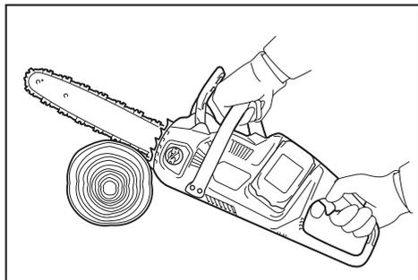
2. Con la cadena de sierra girando, sierre la madera mientras utiliza la empuñadura trasera para levantar la sierra y la delantera para guiarla. Utilice el parachoques de púas como pivote.
