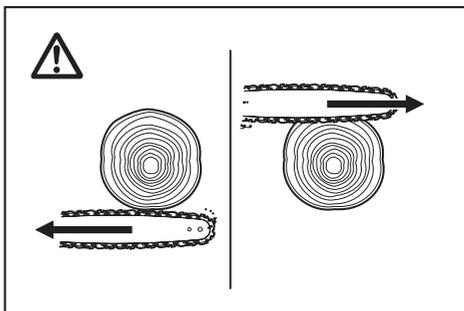
Quando corte una madera que esté bajo tensión, corte primero el lado que está sometido a presión (A). Después haga el corte final desde el lado en tensión (B). De esta forma evitará que la placa quede atrapada.
