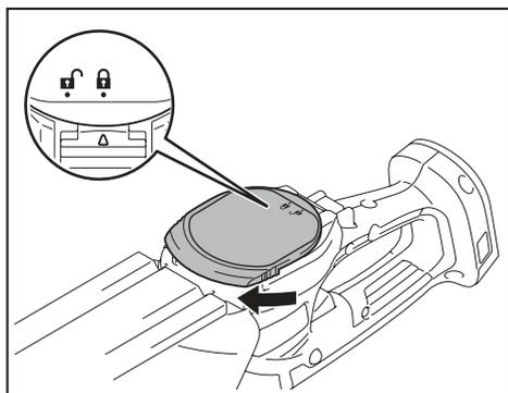
10. Asegúrese de que la palanca de bloqueo encaja en la acanaladura de la cubierta inferior.
