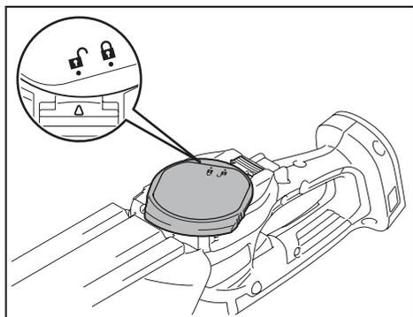
9. Mientras presiona la cubierta inferior, gírela hacia la derecha hasta que
