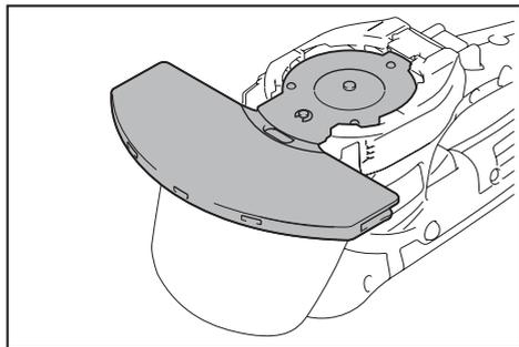
7. Coloque la cubierta inferior de forma que
