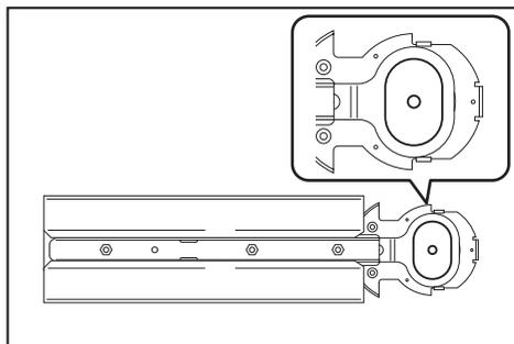
6. Ponga las cuchillas de tijeras cabeza abajo e instélaslas de forma que el pasador de la herramienta encaje en el agujero de las cuchillas de tijeras. Inserte la pinza de la placa base en la acanaladura de la herramienta. Asegúrese de que las cuchillas de tijeras están sujetadas firmemente en su sitio.
