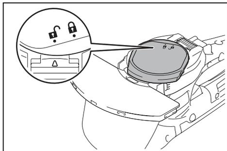
8. Mientras presiona la cubierta inferior, gírela hacia la derecha hasta que
