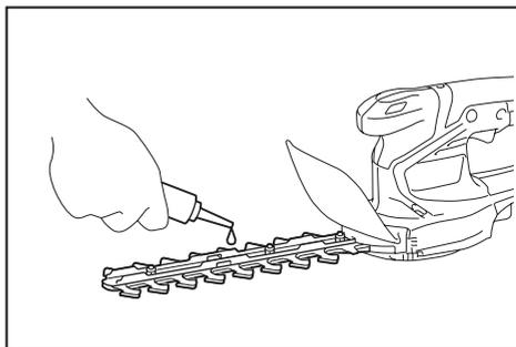
Después de la operación, retire el polvo de ambas caras de las cuchillas con un cepillo de alambres, limpie las cuchillas con un paño y después aplique aceite de baja viscosidad (aceite para máquinas, o aceite de lubricación de tipo aerosol) a las cuchillas.
