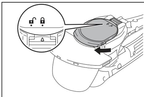
9. Asegúrese de que la palanca de bloqueo encaja en la acanaladura de la cubierta inferior.
