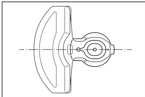
6. Ponga las cuchillas de tijeras cabeza abajo e insértelas de forma que los pasadores de la herramienta encajen en el agujero de la placa base. Asegúrese de que las cuchillas de tijeras están sujetadas firmemente en su sitio.
