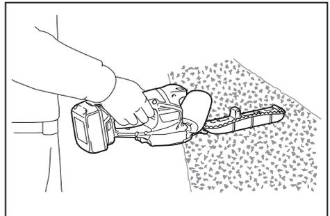
Para operación básica, incline las cuchillas hacia la dirección de recorte y muévala con calma y despacio a una velocidad de 3 a 4 segundos por metro.
