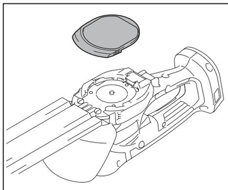
4. Afloje los dos tornillos con un destornillador y retire las cuchillas de tijeras.
