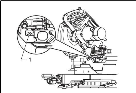
1. Parafuso que segura a caixa da unidade de laser
