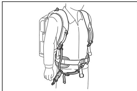
6. Coloque el arnés de hombro en la máquina utilizando el gancho de la cinta colgante. Asegúrese de enganchar el colgador de la máquina.
