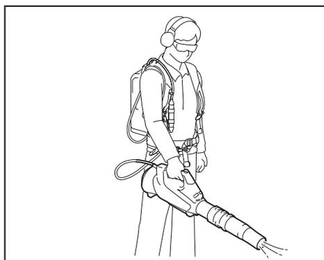
Cuando vaya a poner la máquina en el suelo, desbloquee la hebilla de la cinta colgante con una mano mientras sujeta la máquina con la otra mano.
