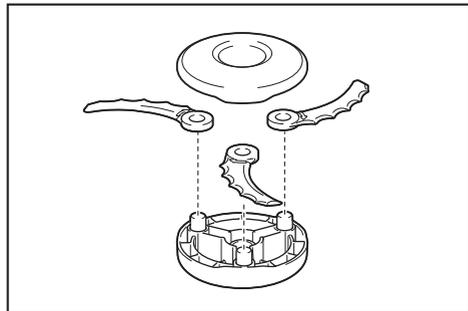
Cuando instale la cuchilla de plástico, alinee la dirección de la flecha de la cuchilla con la del protector.
