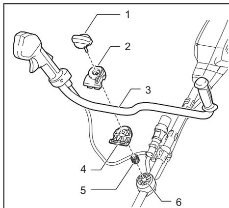
► 1. Perilla 2. Abrazadera del mango 3. Mango 4. Sujetador del mango 5. Resorte 6. Base
