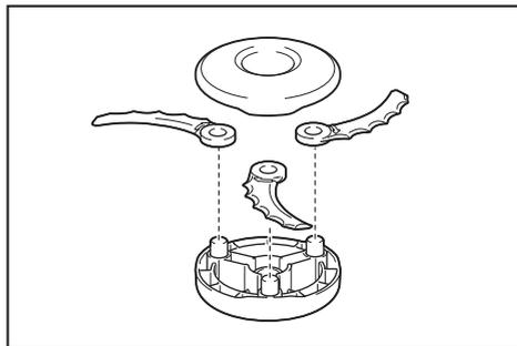
Cuando instale la cuchilla de plástico, alinee la dirección de la flecha en la cuchilla con la del protector.
