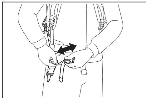
4. Coloque la herramienta en el arnés para el hombro mediante el gancho en la banda para colgado. Asegúrese de engancharse al colgador de la herramienta.
