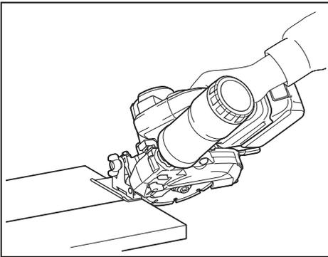
3. Comience a suministrar agua al disco de diamante empujando la palanca de suministro de agua hacia la posición "abierta" (I). El flujo de agua se puede ajustar moviendo la palanca de suministro de agua. Gire la palanca hacia la posición "abierta" (I) para aumentar el flujo, y hacia la posición "cerrada" (O) para reducir el flujo.
