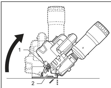
► 1. Tornillo de fijación 2. Placa de escala de bisel
