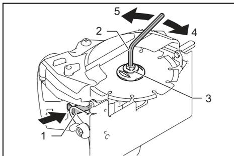
► 1. Bloqueo del eje 2. Llave hexagonal 3. Perno hexagonal 4. Aflojar 5. Apretar
