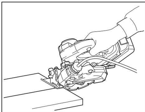
4. Encienda la herramienta y espere hasta que el disco de diamante adquiera plena velocidad. Después mueva la herramienta hacia delante sobre la superficie de la pieza de trabajo, manteniéndola plana y avanzando suavemente hasta completar el corte. Mantenga la línea de corte recta y la velocidad de avance uniforme.
