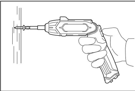
Coloque la punta de la punta de atornillar en la cabeza del tornillo y aplique presión a la herramienta. Después encienda la herramienta. Cuando la cabeza del tornillo y la superficie de la pieza de trabajo se vuelvan planas, suelte el interruptor.
