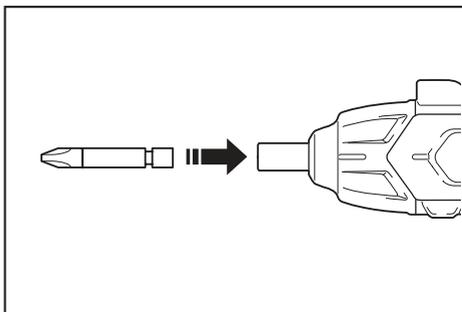
Para instalar una punta de atornillar, empújela firmemente al interior del portapuntas de atornillar. Para retirar la punta de atornillar, extráigala del portapuntas de atornillar.
