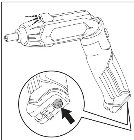
Para encender la luz, presione el interruptor de la lámpara. Para apagar la luz, presione el interruptor de la lámpara otra vez.
