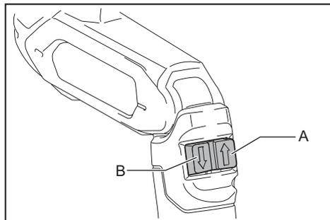
Para poner en marcha la herramienta, simplemente presione el interruptor del lado A para giro hacia la derecha y del lado B para giro hacia la izquierda. Suelte el interruptor para parar.
