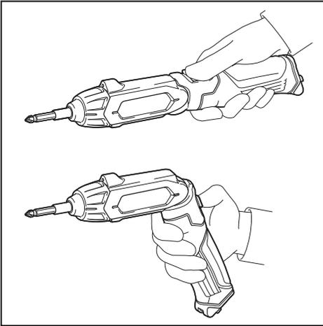
La herramienta se puede utilizar de dos maneras; en forma recta y en forma de pistola que se pueden seleccionar de acuerdo con las condiciones del lugar de trabajo y de atornillado.
