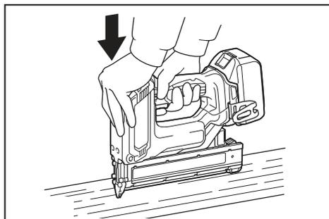
**NOTA:** Si la cabeza del clavo aún queda por encima de la superficie de la pieza de trabajo aunque usted sujete el cabezal de la clavadora, puede que el material no sea apropiado para la clavadora. Si continúa utilizando la clavadora en ese material podrá resultar en daños al impulsor de la clavadora y/o en un atasco de la clavadora.
