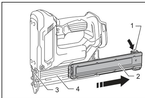
► 1. Palanca de bloqueo 2. Puerta deslizable 3. Guía del impulsor 4. Cargador
