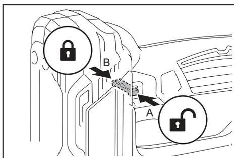
Para evitar que el gatillo interruptor pueda ser apretado accidentalmente, se ha provisto el botón de bloqueo del gatillo. Para apretar el gatillo interruptor, presione hacia dentro el botón de bloqueo del gatillo desde el lado A. Después de utilizar, presione siempre hacia dentro el botón de bloqueo del gatillo desde el lado B.
