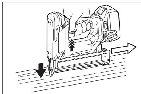
Si la cabeza del clavo queda por encima de la superficie de la pieza de trabajo, clave el clavo mientras sujeta el cabezal de la clavadora firmemente contra la pieza de trabajo.
