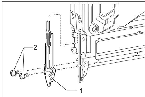
► 1. Cubierta de la guía del impulsor 2. Perno de cabeza hexagonal
