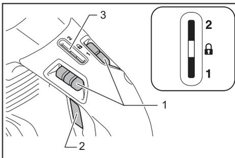
► 1. Palanca de cambio de velocidad/bloqueo
