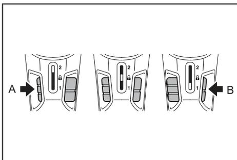
Para poner en marcha la herramienta, presione la palanca de cambio de velocidad/bloqueo desde el lado A o B y apriete el gatillo interruptor.
