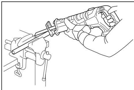
**AVISO:** No corte la pieza de trabajo con la zapata separada de la pieza de trabajo o sin la zapata.
