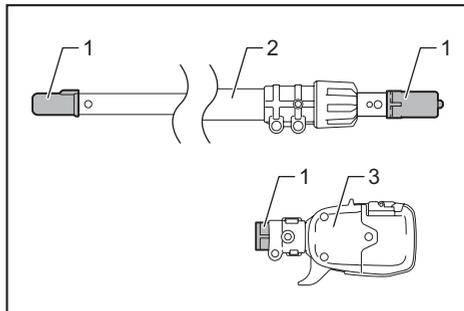
► 1. Tapón 2. Tubo 3. Cabezal de la herramienta
