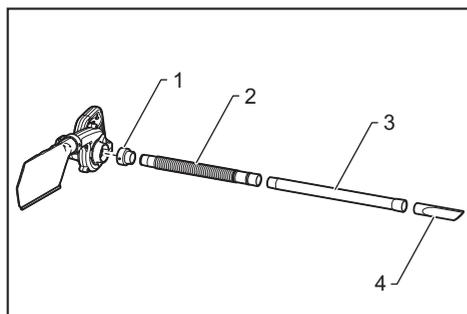
► 1. Acoplador 2. Manguera 3. Tubo 4. Boquilla para bastidores
