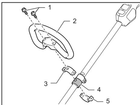
► 1. Perno 2. Mango 3. Abrazadera superior 4. Amortiguador 5. Abrazadera inferior
