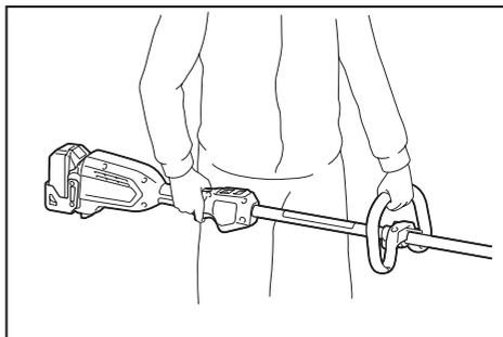
Apriete el gatillo interruptor mientras presiona la palanca, y después mueva la herramienta hacia delante.
