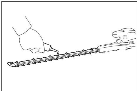
Después de la operación, retire el polvo de ambas caras de las cuchillas de tijeras con un cepillo de alambres, limpie las cuchillas con un paño y después aplique aceite de baja viscosidad (aceite para máquinas, o aceite de lubricación de tipo aerosol) a las cuchillas de tijeras.
