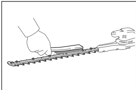
**AVISO:** No lave las cuchillas de tijeras en agua. Si lo hace podrá ocasionar oxidación o daño a la herramienta.
