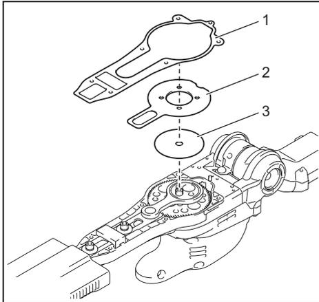
► 1. Empaquetadura 2. Placa A 3. Placa B
