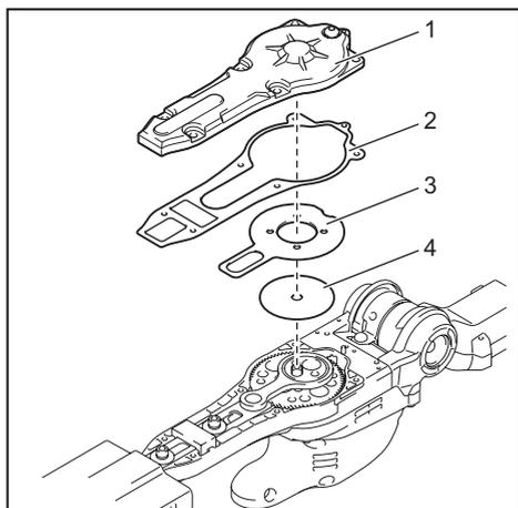
► 1. Cubierta 2. Empaquetadura 3. Placa A 4. Placa B
