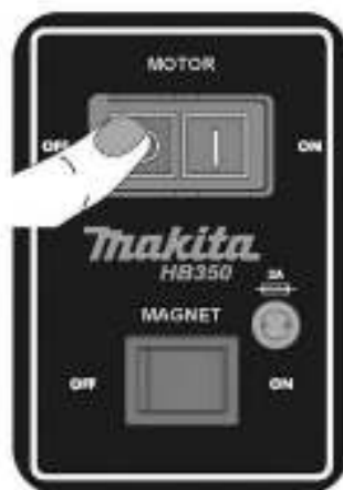
۴) خاموش کردن موتور برای متوقف کردن موتور، کلید "موتور" را فشار دهید. موتور متوقف خواهد شد و آهنربا روشن خواهد ماند. به مرحله ۳ بروید و از ابتدا شروع کنید.
