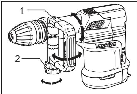
► 1. Empuñadura lateral de doble cara 2. Tuerca de fijación
