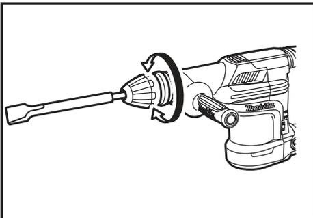
La broca puede fijarse en 12 ángulos diferentes. Para cambiar el ángulo de la broca, deslice la anilla de cambio hacia delante, y a continuación, gire la anilla para cambiar el ángulo de la broca. En el ángulo deseado, deslice la anilla de cambio de vuelta a la posición original. La broca estará firmemente sujeta en su lugar.
