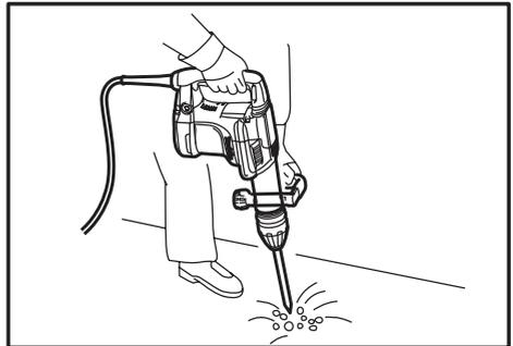
Utilice siempre la empuñadura lateral (mango auxiliar) y sujete firmemente la herramienta por la empuñadura lateral y la empuñadura del interruptor cuando la utilice. Encienda la herramienta y aplique una ligera presión sobre ella para evitar que rebote sin control. Apretar demasiado la herramienta no aumenta la eficacia.
