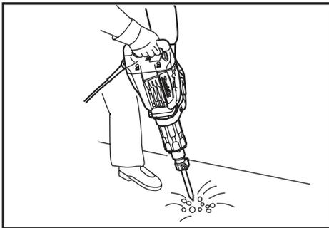
Utilice siempre la empuñadura lateral (mango auxiliar) y sujete firmemente la herramienta por la empuñadura lateral y la empuñadura del interruptor cuando la utilice. Encienda la herramienta y aplique una ligera presión sobre ella para evitar que rebote sin control. Apretar demasiado la herramienta no aumenta la eficacia.
