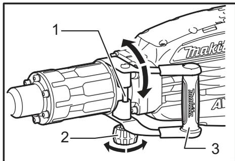
► 1. Perno de fijación 2. Tuerca 3. Empuñadura lateral
