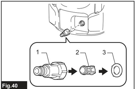
► 1. Conector de la manguera de agua 2. Filtro 3. Anillo obturador
