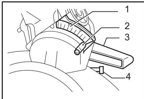
► 1. Escala de bisel 2. Flecha 3. Palanca 4. Perno de ajuste del ángulo de bisel a 45°
