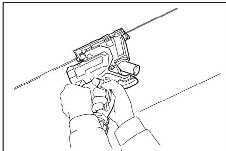
3. Mueva la herramienta hacia adelante en línea recta hasta terminar el corte.
