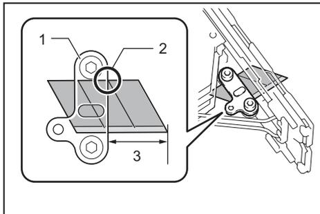
► 1. Porta hoja de sierra 2. Extremo del primer segmento de la cuchilla segmentada 3. Longitud de corte permitida
