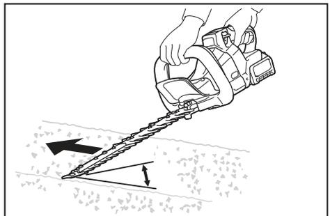
Para cortar uniformemente la parte superior de un seto, ate una cuerda a la altura deseada y recorte a lo largo de ella.
