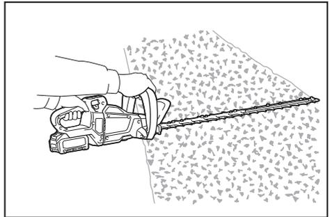
Para operación básica, incline las cuchillas de tijeras hacia la dirección de recorte y muévalas con calma y despacio a una velocidad de 3 a 4 segundos por metro.
