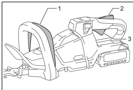
► 1. Palanca interruptor 2. Palanca de desbloqueo
