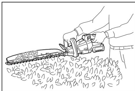
Para cortar el costado de un seto uniformemente, corte desde abajo hacia arriba.
